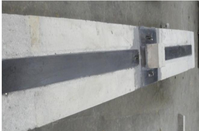
**Fig. 7. CFRP orientation 3 (B3)**
